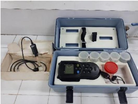
**Imagen 16** Potenciómetro para medir pH
